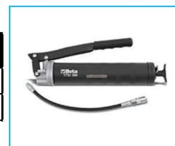
NB: Compressore completo di tubo flessibile e testina a 4griffe.
